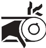
Este símbolo advierte al utilizador de que la máquina contiene unos mecanismos peligrosos. Los cárteres de protección han de quedar colocados durante la utilización.
