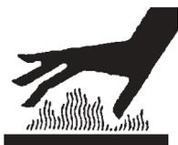
El cilindro de planchado, una vez utilizado, puede alcanzar los 200 °C. (392 °F.) y provocar graves quemaduras al producirse un contacto. Dejarlo enfriar antes de proceder a cualquier intervención de reparación o de mantenimiento.
